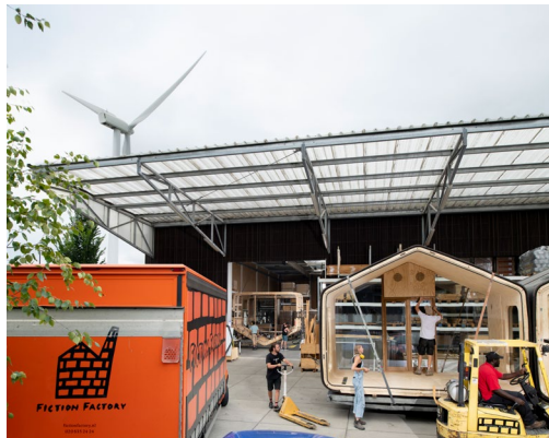
Wikkelse, Amsterdam productie van prefab woningen uit karton, hout en andere grotendeels circulaire materialen, in combinatie met voor- en natransport
