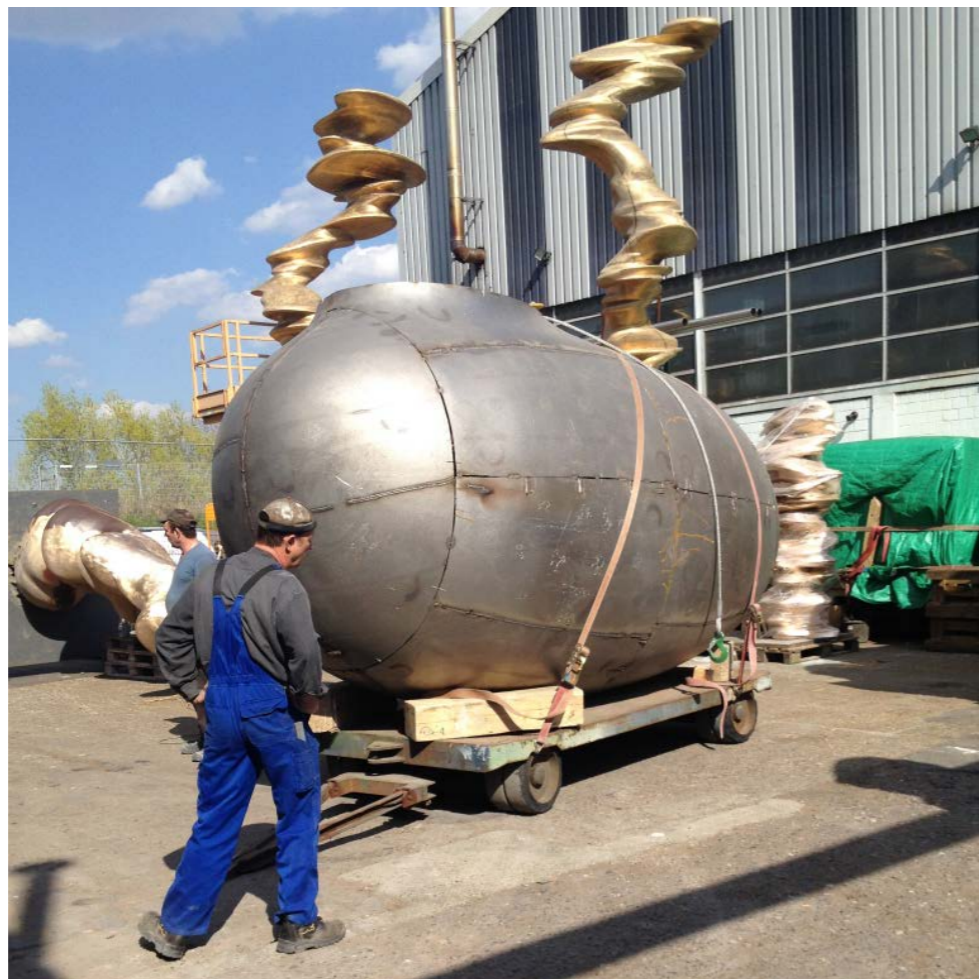
Het samenvoegen van de circa 30 gegoten segmenten en de dragende binnenconstructie tot één sculptuur in de werkplaats van Kunstgiesserei Kayser in Düsseldorf, 2015.
