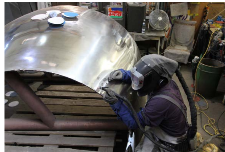
Twee medewerkers van Kunstgiesserei Kayser zijn meer dan 7 maanden bezig geweest met lassen, slijpen en polijsten van de sculptuur. Samen met het invormen en gieten van de segmenten heeft de productie van de wolksculptuur meer dan 12 maanden in beslag genomen.
